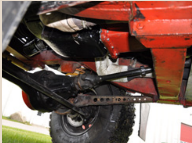
Her ses den ene af de varmeisolerede bananmanifolde
