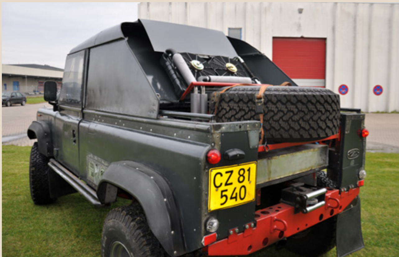
Reservehjul bagest, spil nederunder og køler midtskibs
