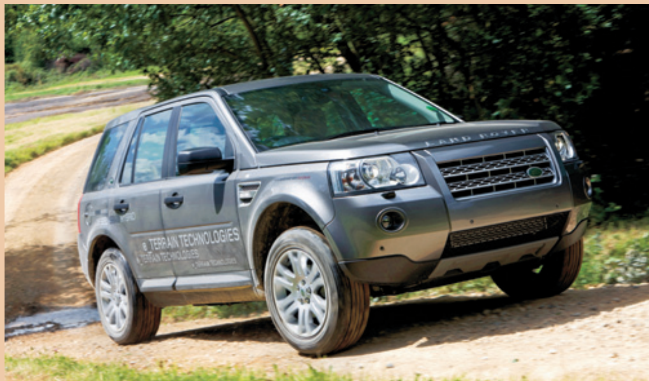
Land Rover har 100 ingeniører i gang med at udvikle fremtidens hybridteknologi som f.eks. denne Freelander med ERAD-teknologi (ERAD = Electric Rear Axle Drive).
