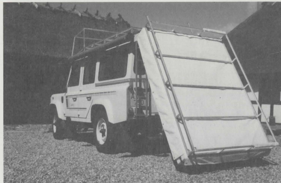
Tagboksen med telt kan takket være ruller monteres af én person.
