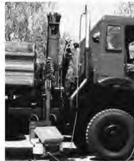
På billedet ses prøveudstyret påmonteret en lastvogns udstødning.
